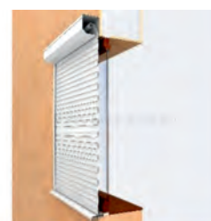
Montaj rulou pe zidul clădirii
